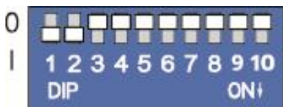
Figure 4 : Commutateurs DIP (réglages usine)
