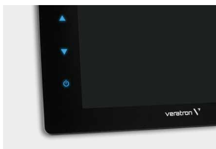
側面に配置されたタッチボタンはRGBイルミネーションを具備、直感的かつ素早い輝度調整をサポート
