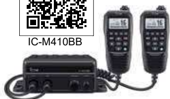
IC-M410BB livrée avec une station déportée HM-195GB (jusqu'à 2 stations)
