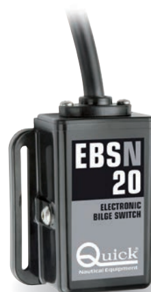
Détecteur d'eau électronique avec temporisation de sécurité à la mise en route et à l'arrêt. Ne pas utiliser avec gasoil. Temporisation au démarrage 6", à l'arrêt 23". Dimensions : H 85 x l 75 x épaisseur 35mm. Réf: QS010 Max 10A Réf: QS015 Max 15A Réf: QS020 Max 20A
