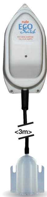
Contacteur à déclenchement automatique 55mm en fond de cale. Arrêt automatique maximum à 25mm d'eau. Température entre 0 et 50°C. Protection du contact (ISO 8846 Marine). Réf: JA007 12V Max 20A Réf: JA072 24V Max 10A
